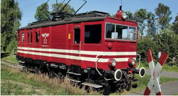
E-Lok Nr. 22 (Eigentum VBE), Baujahr 1927, 600 PS, 34 t, 30 km/h
