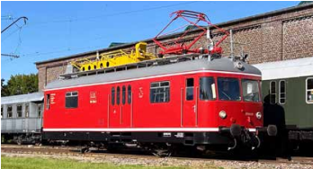
Turmtriebwagen 701 119-0, Baujahr 1968, 300 PS, 24,6 t, 90 km/h
