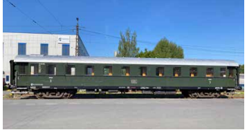
Fähr-Schnellzugwagen C4ü 16 223 Baujahr 1929, 21,7 m, 39,4 t, zugel. bis 120 km/h
