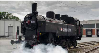
Dampflok 93 1410, (z. Zt. in Aufarbeitung) Baujahr 1928, 783 PS, 66 t, 60 km/h
