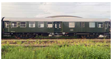
Umbauwagen BD4yg 98 045 Baujahr 1959, 19,5 m, 30,4 t, zugel. bis 120 km/h
