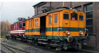
E-Lok Nr. 21 (Eigentum VBE, z. Zt. abgestellt), Baujahr 1927, 600 PS, 34 t, 30 km/h
