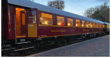
Speisewagen WR4ü 1122 Baujahr 1936, 23,5 m, 52,9 t, zugel. bis 120 km/h
