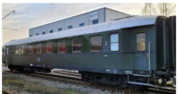
Schnellzugwagen B4üw 17 197 Baujahr 1927, 21,5 m, 39 t, zugel. bis 120 km/h
