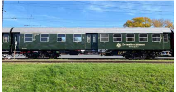
Umbauwagen AB4yg 34 039 Baujahr 1959, 19,5 m, 30 t, zugel. bis 120 km/h
