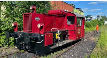
Kleindiesellok Köf 6815, Baujahr 1965, 125 PS, 17 t, 45 km/h
