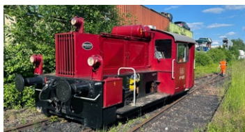
Kleindiesellok Köf 6815, Baujahr 1965, 125 PS, 17 t, 45 km/h
