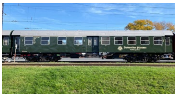
Umbauwagen AB4yg 34 039 Baujahr 1959, 19,5 m, 30 t, zugel. bis 120 km/h
