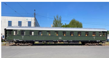
Fähr-Schnellzugwagen C4ü 16 223 Baujahr 1929, 21,7 m, 39,4 t, zugel. bis 120 km/h
