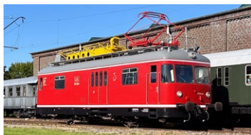
Turmtriebwagen 701 119-0, Baujahr 1968, 300 PS, 24,6 t, 90 km/h
