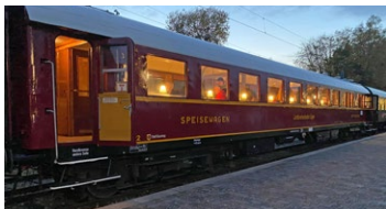
Speisewagen WR4ü 1122 Baujahr 1936, 23,5 m, 52,9 t, zugel. bis 120 km/h
