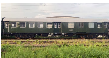
Umbauwagen BD4yg 98 045 Baujahr 1959, 19,5 m, 30,4 t, zugel. bis 120 km/h
