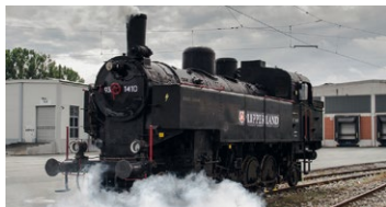
Dampflok 93 1410, (z. Zt. in Aufarbeitung) Baujahr 1928, 783 PSi, 66 t, 60 km/h
