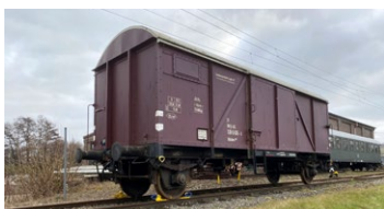
Güterwagen Gkklms Baujahr 1949, 10 m, 10 t, zugel. bis 100 km/h
